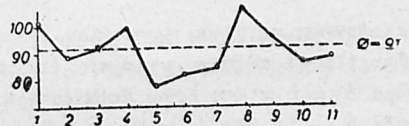
Σχ. 11. Κινήσις τῆς ἐργασιακῆς ἀποδόσεως 10 σιδεράδων μπετόν κατὰ τὴν διάρκειαι 11ωρης ἐργασίας.
